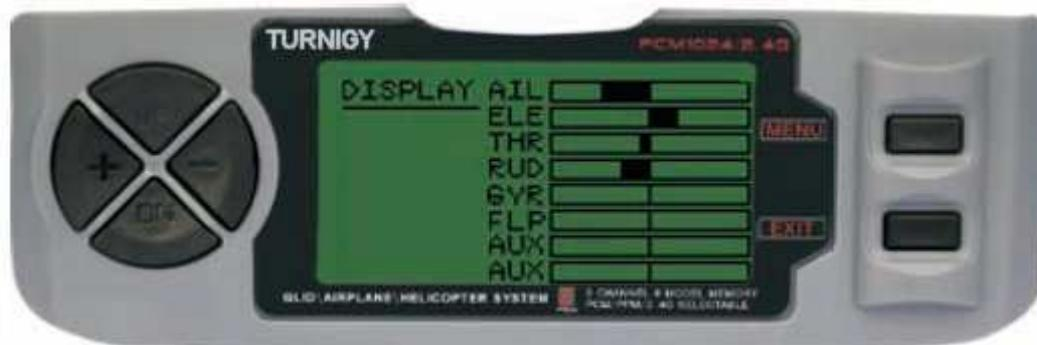
Dans le MENU REGLAGES appuyez sur FUNC. Puis, en utilisant l'UP DISPLAY / DOWN et appuyez sur la fonction de menu pour l'accès. Puis de nouveau avec UP / DOWN pour sélectionner ON / OFF pour activer ou désactiver la vérification. Une fois fait, appuyez sur MENU pour revenir au menu précédent et sur Sortir pour quitter.
