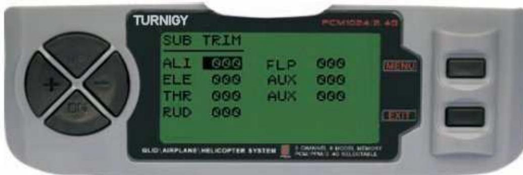
Dans le MENU REGLAGES appuyez sur FUNC. Puis, en utilisant les touches UP / DOWN sélectionner la fonction SUB TRIM et appuyez sur MENU pour accéder. Puis de nouveau avec UP / DOWN sélectionner le canal que vous souhaitez ajuster. Maintenant, avec les touches + / - régler la position du servo pour ce canal. Une fois terminé, appuyez sur MENU pour enregistrer la nouvelle position et revenir au menu précédent. Ou appuyez sur EXIT pour quitter sans enregistrer les modifications.
