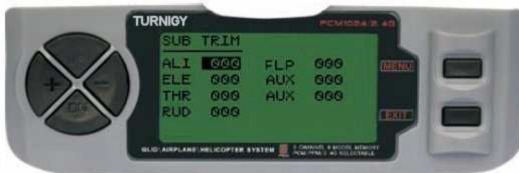
Dans le MENU REGLAGES appuyez sur FUNC. Puis, en utilisant les touches UP / DOWN sélectionner la fonction SUB TRIM et appuyez sur MENU pour accéder puis de nouveau avec UP /DOWN sélectionner le canal que vous souhaitez ajustez
