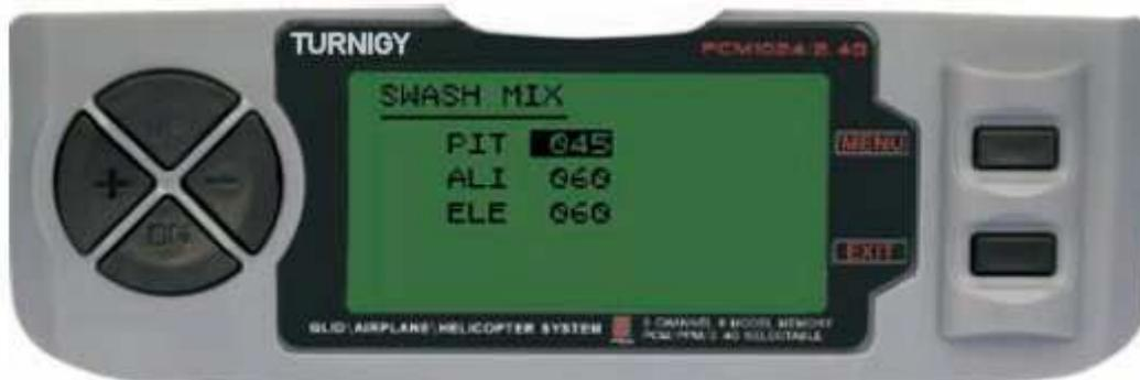
Dans le MENU REGLAGES appuyez sur FUNC. Puis, en utilisant le MENU UP / DOWN sélectionnez OSCILLANT MIX fonction et appuyez sur pour accéder. Puis de nouveau avec UP / DOWN sélectionnez le contrôle pour ajuster maintenant, avec les touches + / - ajuster le dosage. Une fois fait, appuyez sur MENU pour enregistrer et revenir au menu précédent. Ou appuyez sur EXIT pour quitter sans enregistrer les modifications.
