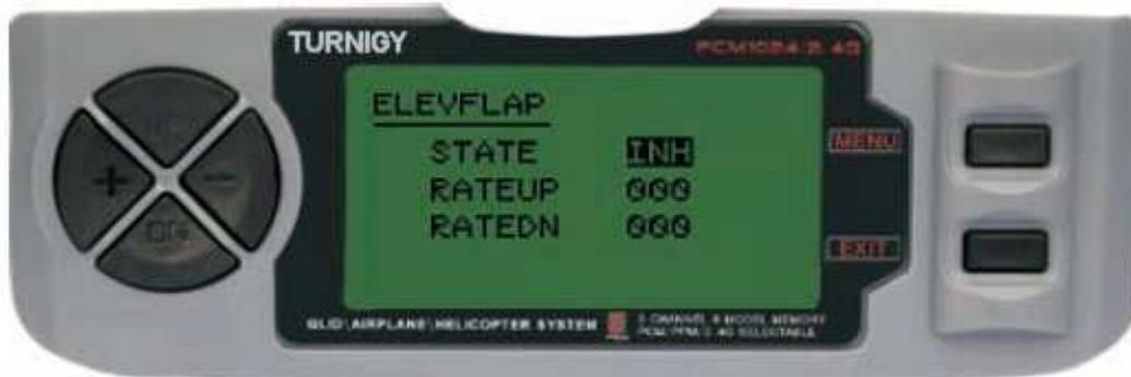
Dans le MENU REGLAGES appuyez sur FUNC. Puis, en utilisant l'UP MENU / DOWN fonction AILBRAKE sélectionner et appuyez sur pour accéder. Puis, avec les touches + / - sélectionnez l'INH ou ACT pour activer ou désactiver cette fonctionnalité. Une fois cela fait, à nouveau avec les touches + / - donner le réglage souhaité pour les volets. Ensuite, appuyez sur MENU pour enregistrer les modifications et retourner au menu précédent, ou sur EXIT pour annuler.
