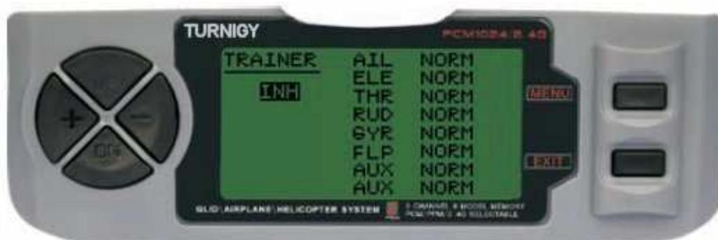
Dans le MENU REGLAGES appuyez sur FUNC. Puis, en utilisant l'UP MENU / DOWN fonction TRAINER sélectionner et appuyez sur pour accéder. Puis, avec les touches + / - sélectionner NORM ou FUNC pour chaque canal. Une fois fait, appuyez sur MENU pour enregistrer et revenir au menu précédent. Ou appuyez sur EXIT pour quitter sans enregistrer les modifications.
