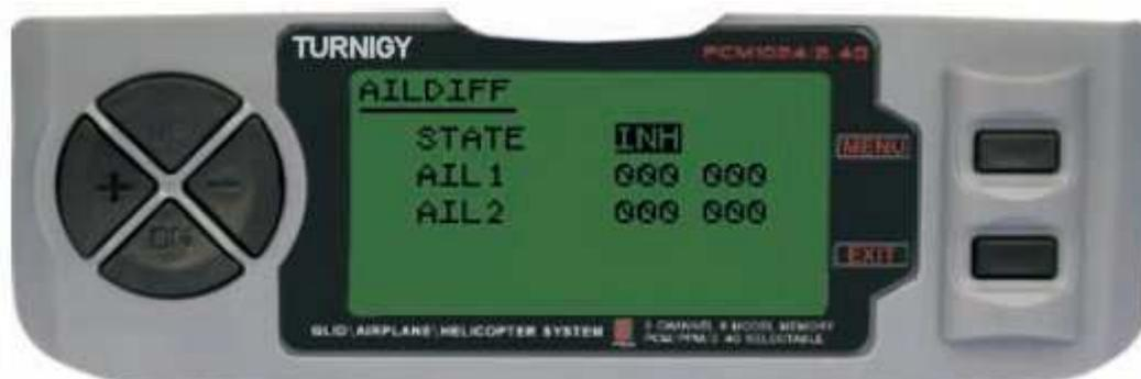
Les ailerons et les volets ne peuvent pas travailler dans la mode AIL-DIFF, sauf s'ils sont configurés en tant que freins à air comprimé. Gardez à l'esprit que vous avez activé la FLAP-TRIM en utilisant AIL-DIFF, cela n'a aucun effet sur les ailerons. Fonction Airbrake seul peut contrôler les volets en mode volets, avec le mode AIL-DIFF.
