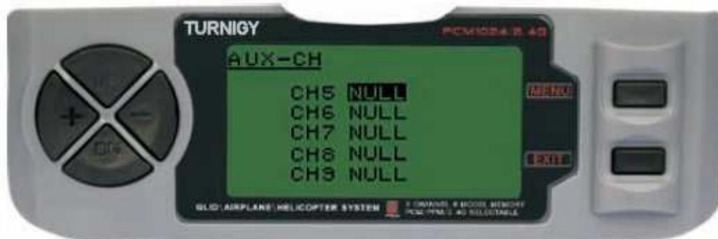
Dans le MENU REGLAGES appuyez sur FUNC. Puis, en utilisant les touches UP / DOWN sélectionnez le AUX-CH et appuyez sur MENU pour accéder. Puis de nouveau avec UP / DOWN sélectionner le canal que vous souhaitez ajuster. Maintenant, avec les touches + / - régler le canal désiré. Une fois fait, appuyez sur MENU pour enregistrer et revenir au menu précédent. Ou appuyez sur EXIT pour quitter sans enregistrer les modifications.
