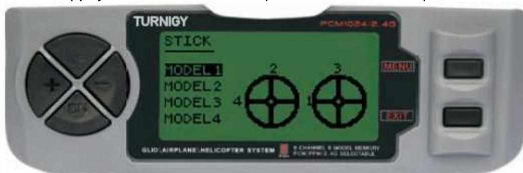
MODELE 1: Stick analogique droit, UP / DOWN: Accelérateur -droite / gauche: Aileron
