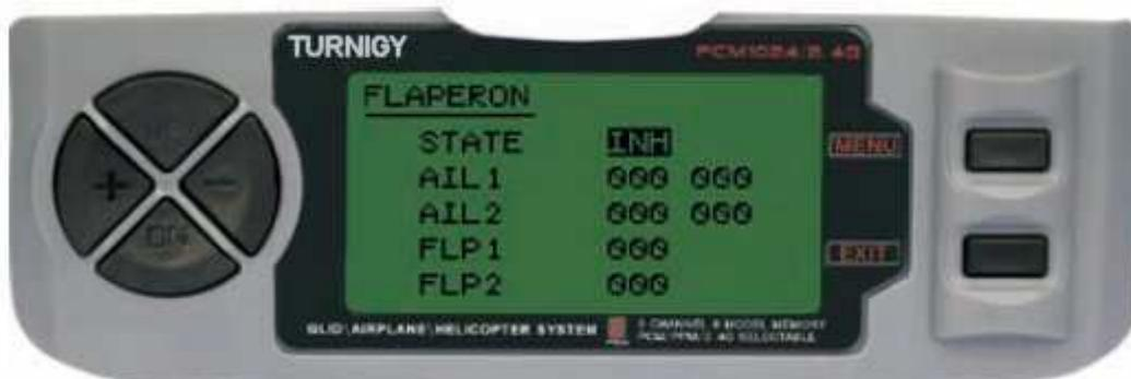
Dans le MENU REGLAGES appuyez sur FUNC. Puis, en utilisant le MENU UP / DOWN et sélectionner la fonction Flaperons appuyez sur pour accéder. Puis, avec les touches + / - Sélectionner ETAT: INH = Off / ACT = activé. Ensuite, et avec + / - de modifier les valeurs AIL1 (Spoiler 1), AIL2 (Spoiler 2), FLP1 (Volet 1), FLP2 (Flap 2) dans la plage affectée. Une fois fait, appuyez sur MENU pour enregistrer les modifications et retourner au menu précédent, ou sur EXIT pour annuler.
