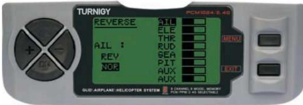
Servo Reverse fonction vous permet d'inverser le fonctionnement de la servos. Cette fonctionnalité est disponible dans le canal 9 9Xéquipe Turnigy.
