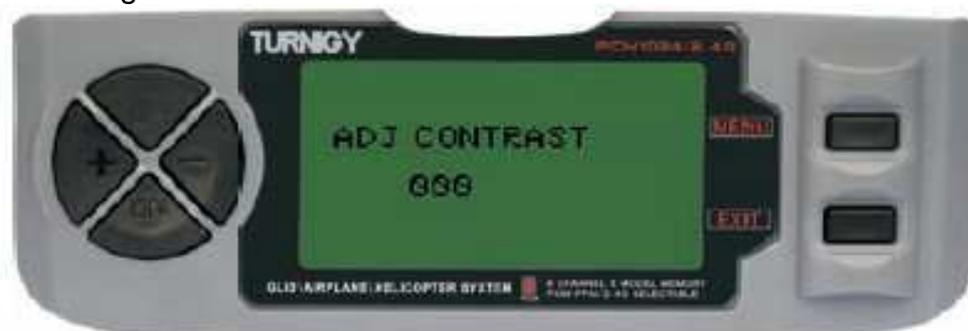
Dans le menu Réglages Système, sélectionnez CONTRASTE ADJ, puis appuyez sur MENU. Puis, en utilisant les touches + / - peut modifier le contraste du texte à l'écran. Une fois la correction, brièvement appuyé sur MENU. Cela permettra d'économiser la nouvelle valeur de contraste, et revenir au menu précédent.
