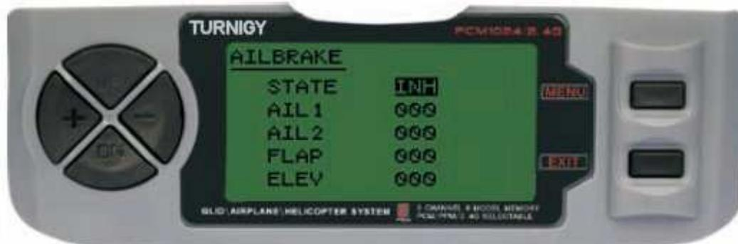
Cette fonctionnalité peut être utilisée dans les modèles qui n'ont pas les volets eux-mêmes, à travers le cas échéant Flaperons mix-LIFT FLAP et conjointement.
