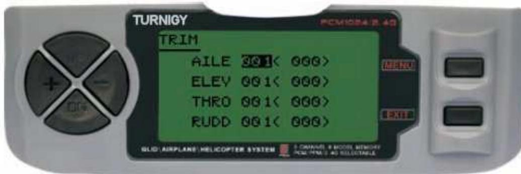
Dans le MENU REGLAGES appuyez sur FUNC. Puis, en utilisant le MENU UP / DOWN sélectionnez la fonction TRIM et appuyez sur pour accéder. Puis de nouveau avec UP / DOWN sélectionnez la garniture pour s'adapter. Maintenant, avec les touches + / - définir le même. Une fois fait, appuyez sur MENU pour enregistrer et revenir au menu précédent. Ou appuyez sur EXIT pour quitter sans enregistrer les modifications.
