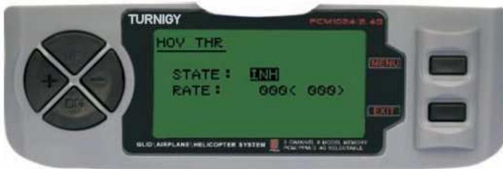
Dans le MENU REGLAGES appuyez sur FUNC. Puis, en utilisant les touches UP / DOWN sélectionner la fonction et appuyez sur MENU THR HOV accès puis, avec les touches + / - sélectionnez l'INH ou ACT. Une fois cela fait, changer le réglage. Ensuite, appuyez sur MENU pour enregistrer et revenir au menu précédent ou appuyez sur EXIT pour quitter sans enregistrer les modifications.
