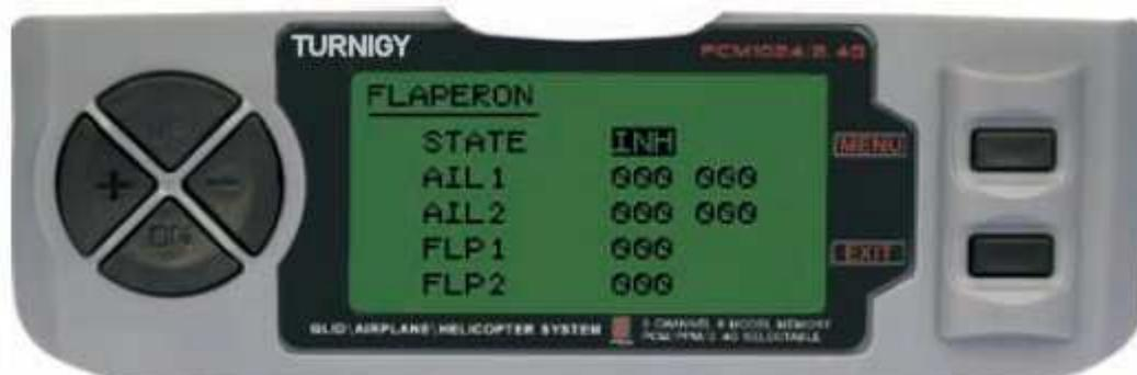
Dans le MENU REGLAGES appuyez sur FUNC. Puis, en utilisant le MENU UP / DOWN et sélectionner la fonction Flaperons appuyez sur pour accéder. Puis, avec les touches + / -
