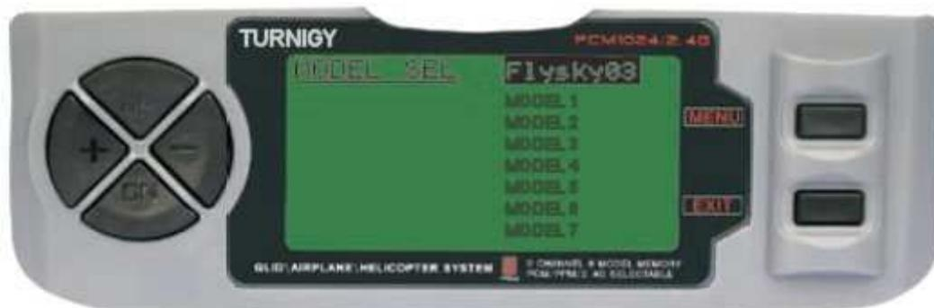
Dans le menu Réglages Système, sélectionnez **MODELE SEL**, puis appuyez sur **MENU**. Ensuite, (et également en utilisant les touches **UP / DOWN**) moduler et de choisir l'option en utilisant les touches **UP / DOWN** sélectionnez le type de modulation souhaitée pour ce modèle. Puis confirmer l'option sélectionnée en appuyant sur **MENU**. Ensuite, appuyez sur le bouton **EXIT** pour revenir au menu précédent.
