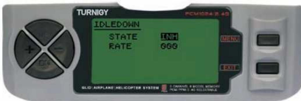
Dans le MENU REGLAGES appuyez sur FUNC. Puis, en utilisant le MENU UP / DOWN et sélectionner la fonction IDLEDOWN appuyez sur pour accéder. Puis, avec les touches + / - Sélectionner ETAT: INH = Off / ACT = activé. Ensuite, et avec + / - set / assigne la valeur de l'accélération souhaitée. Une fois fait, appuyez sur MENU pour enregistrer et revenir au menu précédent. Ou appuyez sur EXIT pour quitter sans enregistrer les modifications.
