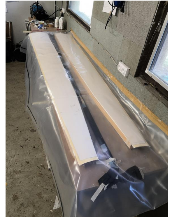
Tirage au vide. Recouvrir avec la dépouille et mettre du poids.
