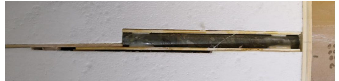
Dépose des longerons
