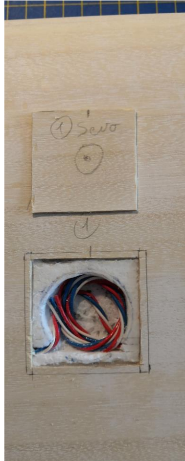
Les caches des servos sont découpe au disque fin
