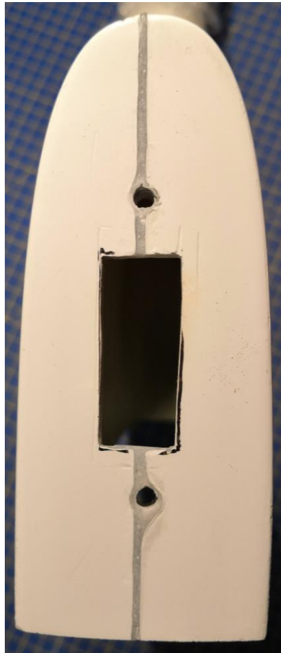
Photo de la dérive avant et après perçage pour passage du servo pour le stabilisateur
