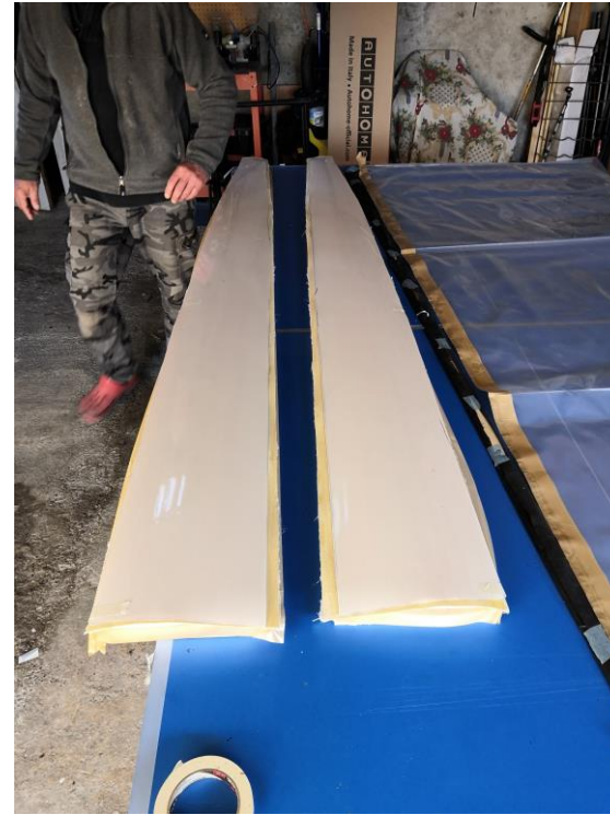
Déposer et scotcher le mylar à la dépouille
