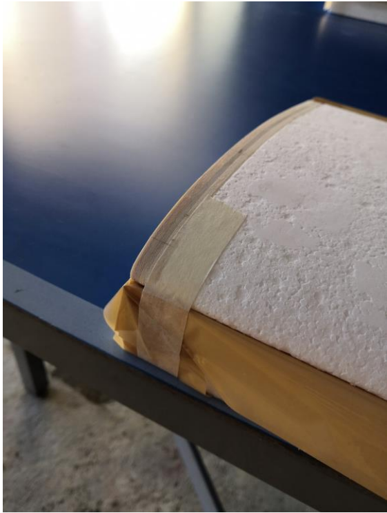
Scotcher les noyaux sur les dépouilles pour les fixer
