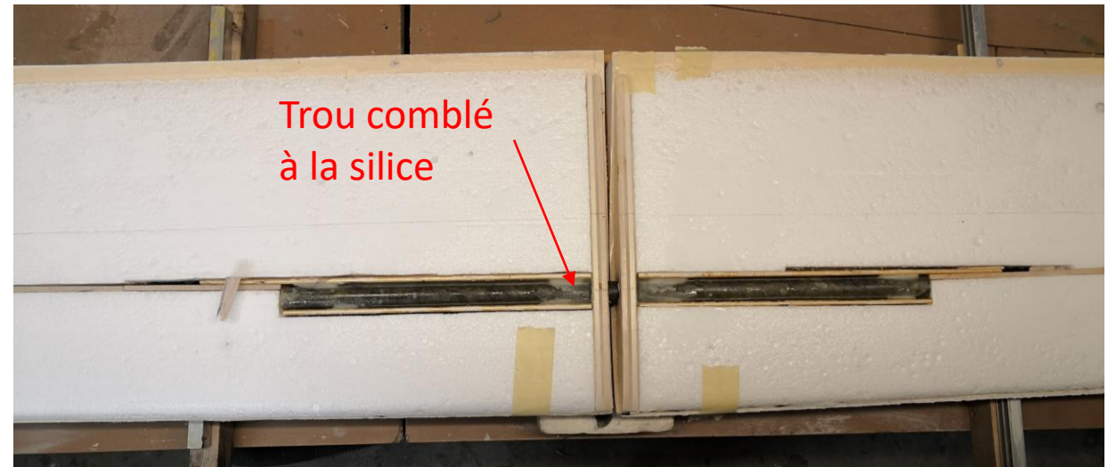
Dépose des longerons
